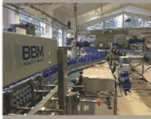
un supporto a 360°: dallo studio preliminare ed engineering della linea fino alla fornitura completa della linea composta da macchinari usati-revisionati e di nuova fabbricazione, con una capacità produttiva di 16.000 bph.
