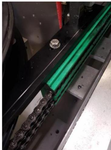
Come si vede dalla foto a lato si notano segni di usura abbastanza importanti sulle forchette della ruota traino del forno.
