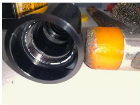
Come si vede dalla foto a lato i blocchi di tenuta ugello risultano particolarmente usurati sull'interno causa sfregamento della molla si raccomanda la sostituzione di questo particolare su tutte le stazioni durante la prossima manutenzione.
