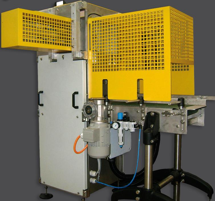
**Sovrapositore automatico a salita compatto e versatile** per la creazione di formati multistrato di astucci, scatole ed altri prodotti di diverse forme e dimensioni.
