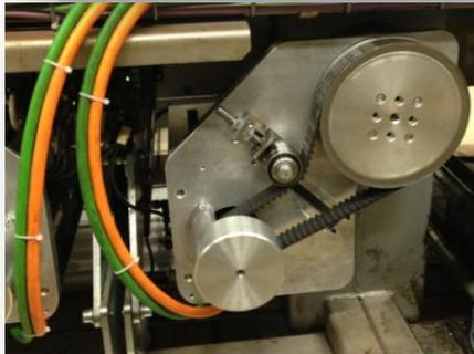
Sostituzione del sistema frenante idraulico del mandrino bobina con brushless.
