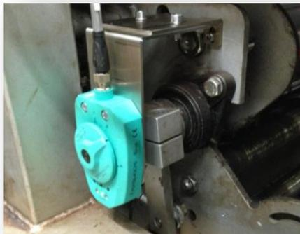
Sostituzione attivazione del sistema frenante idraulico del mandrino bobina con trasduttore di posizione.
