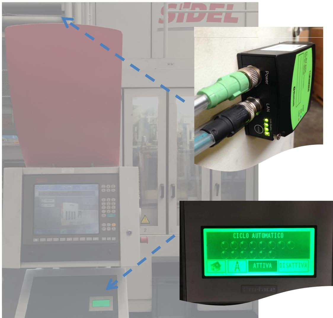
Il sistema così configurato consente la regolazione automatica mentre la macchina è in funzione in base al formato e alla velocità della soffiatrice stessa.
