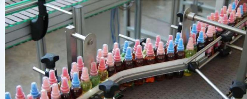
Los sistemas Pick & Place son soluciones compactas y versátiles para el manejo de productos de diferente naturaleza; se utilizan para crear configuraciones de múltiples capas, para mover / transferir o insertar productos en cajas, bandejas, blisters, etc. **Cada Pick and Place está personalizado para el producto a tratar y para la aplicación requerida, garantizando la flexibilidad necesaria para cada uso.**
