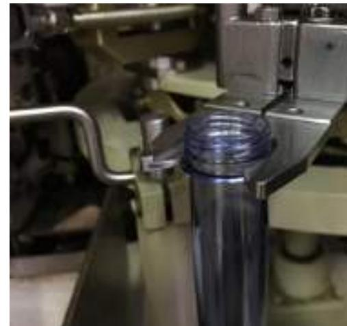
Pinze e particolari di presa delle preforme riscaldate dal forno alla stazione di soffiaggio
