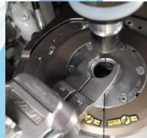
Changement des accessoires de la cavité de soufflage, des pinces et des détails pour l'extraction et la sortie de récipients soufflés
