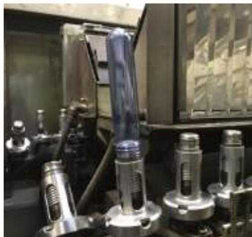
Remplacement des détails du four, nécessaire pour la variation du diamètre ou de la hauteur du goulot
